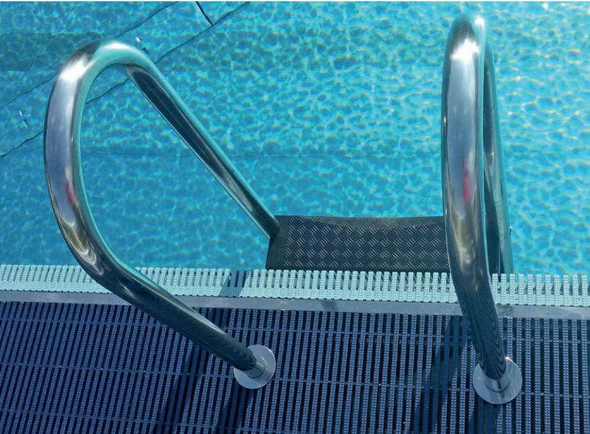
Le scalette Zetapool nascono dalla necessità di facilitare l'ingresso e l'uscita dalla vasca. Sono composte da due montanti tubolari in acciaio inox AISI 316 lucido di diametro Ø 45 mm con un interasse di 500 mm, e da gradini di colore nero in copolimero plastico resistente agli agenti chimici presenti nell'acqua. I gradini hanno un'alzata di 270 mm ed una pedata di 130 mm. Specifici tamponi in EPDM consentono l'appoggio della scala alla parete della piscina.
